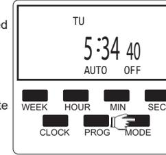
5.4 (Apagado AUTOMÁTICO): Pulse el botón (Mode) desde (OFF) a (AUTO). En este estado, el indicador Led rojo está apagado, el temporizador permanecerá apagado hasta la siguiente configuración de encendido. Y luego funcionará exactamente como lo programó.
