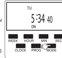
5.3 (Encendido AUTOMÁTICO): Pulse el botón (Mode) desde (ON) a (AUTO). En este estado, el indicador Led rojo está ENCENDIDO, el temporizador permanecerá encendido hasta la siguiente configuración de apagado. Y luego funcionará exactamente como lo programó.
