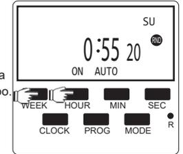
Al iniciar el modo aleatorio, el temporizador encenderá y apagará aleatoriamente con una variación de 2-32 minutos basada en el horario programado anteriormente. La función aleatoria solo puede funcionar cuando el temporizador haya terminado el seteo y el tiempo en modo automático. Pulse (Week) y (Hour) de nuevo para salir de este modo.
