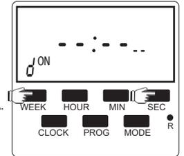
Puede presionar (Hour), (Min) y (Sec) para establecer el tiempo de cuenta regresiva que desea. La duración de la cuenta regresiva puede setearse desde 1S a 99h59m. Pulse (Mode) para cambiar encender o apagar el modo Cuenta regresiva. Pulse (Week) y (Sec) de nuevo para salir de este modo.
